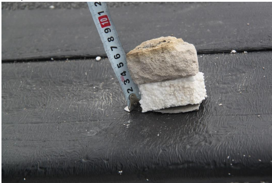
Pobrana próbka/część stara/ – gładź, styropian, papa
